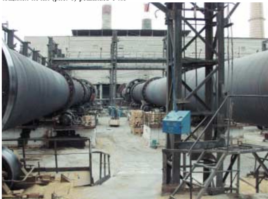
Рис. 1. Комплекс вращающихся печей цеха магниальных порошков ЦМП-3 ОАО «Комбинат Магнезит»
