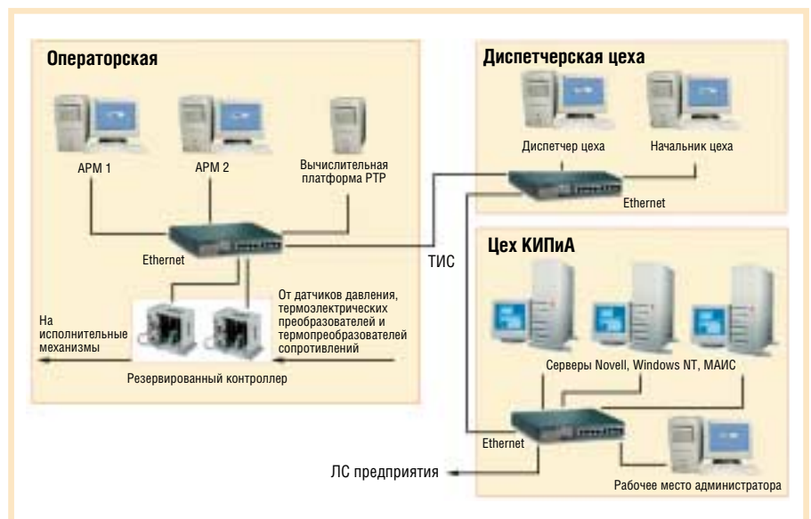
Рис. 4. Структурная схема АСУ ТП комплекса вращающихся печей ЦМП-3
